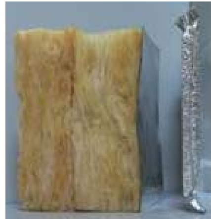
Figur 7.12 Jämförelse mellan mineralull och VIP.
