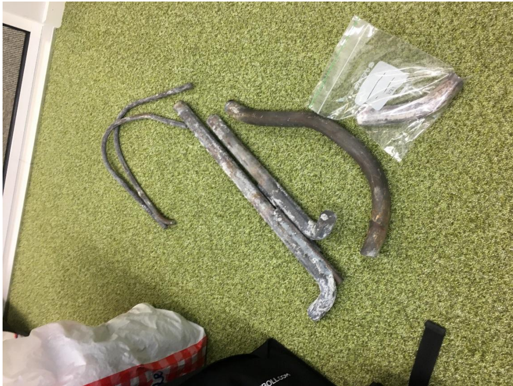
Kuva 28 vetokokeisiin lähetetyt tangot (2 kpl) kuvassa keskellä selätysten
