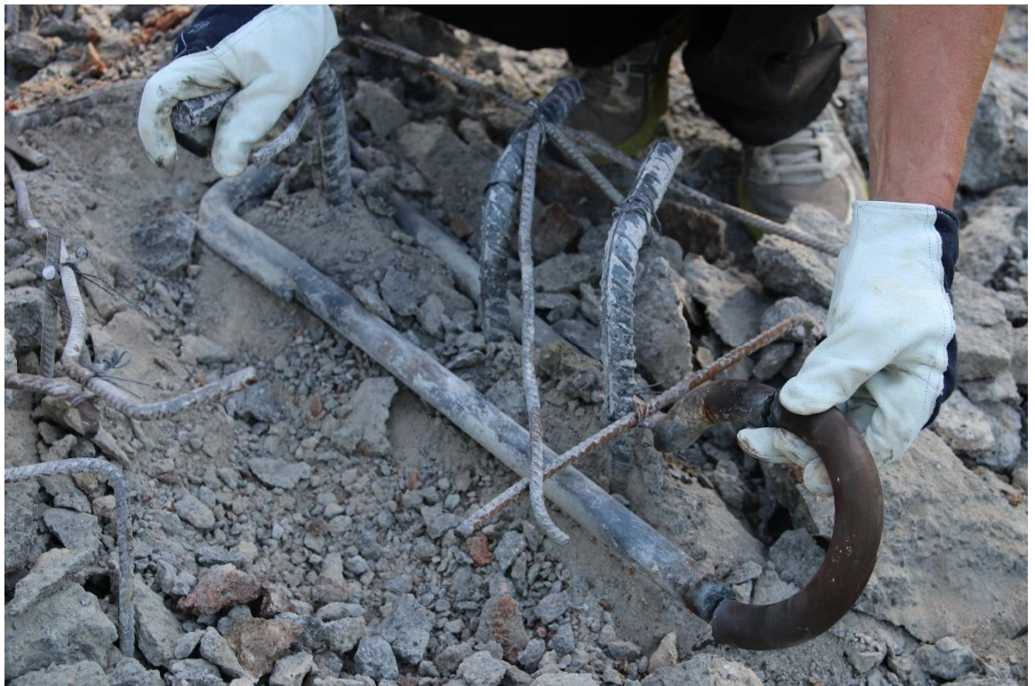
Kuva 27 pettänyttä viereisen vastapainon ankkuritangot.
