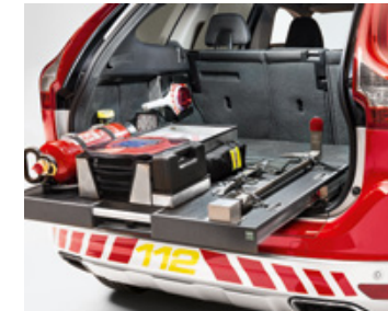
Ladeboden Zum Transport der Ausrüstung (ausgefahren)
