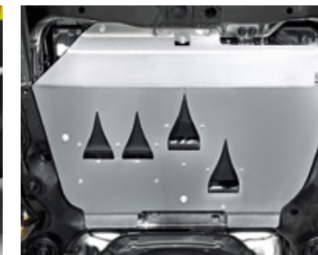
Unterfahrschutz Zur Absicherung des Motors, aus 5 mm Aluminiumblech
