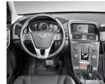
Steuereinheit Für die Signal- und Funkanlage
