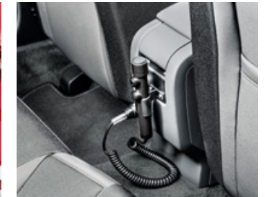
Mikrofon Für Durchsagen über die Signalanlage
