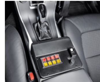
Bedienfeld Für die Signal- und Funkanlage auf der Mittelkonsole
