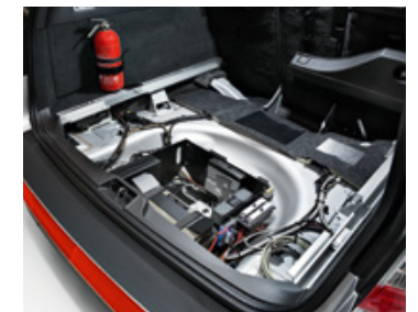
Elektronikvorbereitung Für die Stromversorgung der Zusatztechnik
