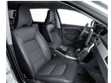
Mischpolsterung Aus strapazierfähigem Teilleder (vorn) und abwaschbarem Vinylleder (hinten)
