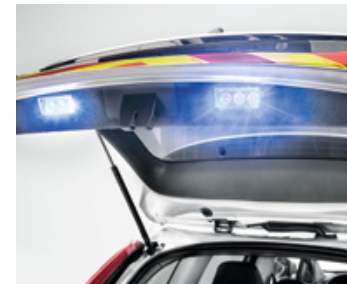
LED-Heckblitzer Für die Signalisation bei geöffneter Heckklappe
