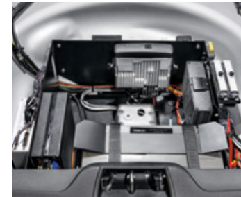
Elektronikvorbereitung Für die Stromversorgung der Zusatztechnik
