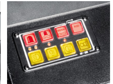
Bedienfeld Für die Signal- und Funkanlage auf der Mittelkonsole
