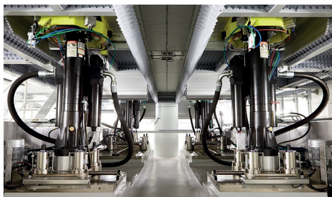
Infrastructure d'essais de résistance aux secousses
