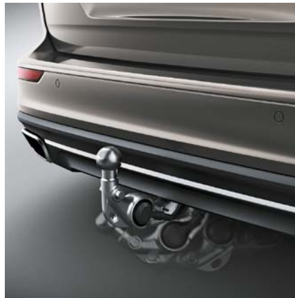
Crochet d'attelage amovible semi-électrique 13 broches. Charge max. 100 kg. 1200 €
