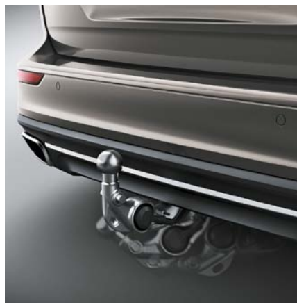
Crochet d'attelage amovible semi-électrique 13 broches. Charge max. 100 kg. Poids remorquable max. 2000 kg.
