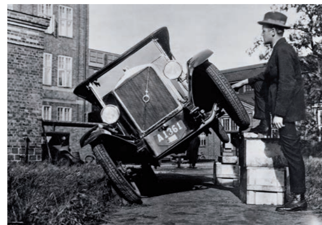
Basculera ? Basculera pas ? En 1926, le Centre de sécurité était encore rudimentaire mais il existait déjà ! Et ce prototype de la première Volvo ÖV4 commercialisée l'année suivante a dû passer l'épreuve.
