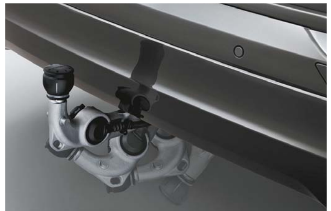
Crochet d'attelage amovible semi-électrique 13 broches. Charge max. 140 kg. Poids remorquable max. de 2 400 kg.
