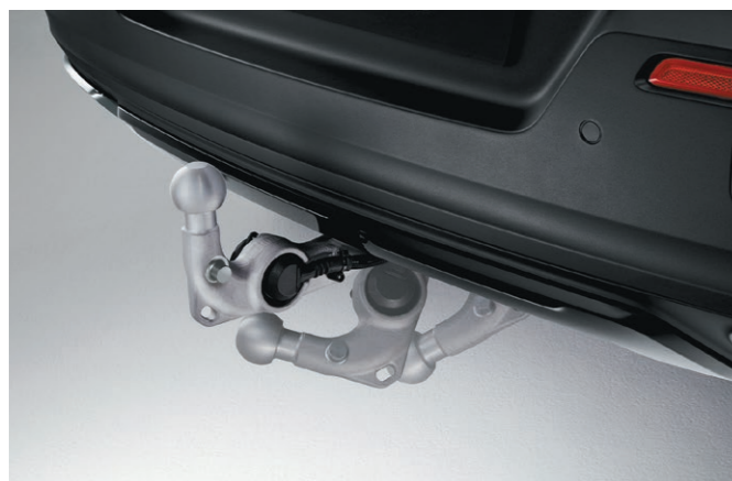
Crochet d'attelage amovible semi-électrique 13 broches. Charge max. 80 kg. Poids remorquable max. 1500 kg.
