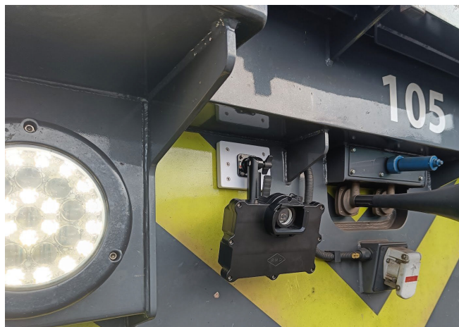
RMD:S backkamera på ett av Green Cargos lok
