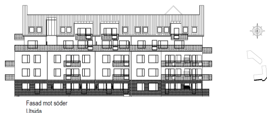
Kv. Hercules södra hus före ändringen av fasaden där balkongräcket ramar in terrasserna på fjärde våningen
