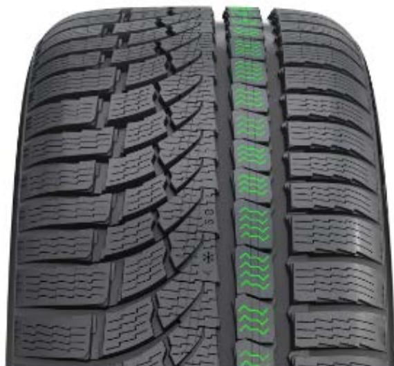
La zona centrale è dominata da robuste nervature longitudinali costituite da blocchi del battistrada con lamelle seghettate che somigliano all'impronta di un millepedi. Il **Centipede Siping** tridimensionale ripartito garantisce la massima superficie di contatto e funziona pienamente a vari angoli di sterzata, aumentando l'aderenza sulla neve e sul fango e migliorando il controllo.
