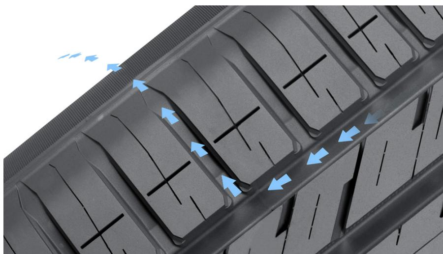
La technologie Coanda de Nokian Tyres accélère l'évacuation de l'eau des rainures longitudinales, protégeant efficacement le pneu contre l'aquaplaning. La forme incurvée en rampe des blocs de profilé sur l'épaulement intérieur guide et accélère l'écoulement de l'eau depuis la rainure longitudinale vers la rainure transversale. L'effet Coanda souligne la tendance de l'écoulement à
