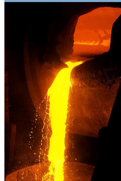
Tappning av koppar i Rönnskär.
