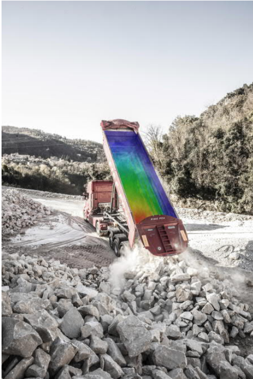
Bild 3 Mit Hilfe von Software wie WearCalc von SSAB kann die Verschleißrate bereits vor der Herstellung der Kippereaufbauten berechnet werden. Die verschiedenen Farben zeigen den Gleitverschleiß nach dem Entladen des Kippers an. Daten aus den Berechnungen geben dem Hersteller die Grundlage für Empfehlungen für Materialaufrüstungen und die Verschleißkonstruktion.
