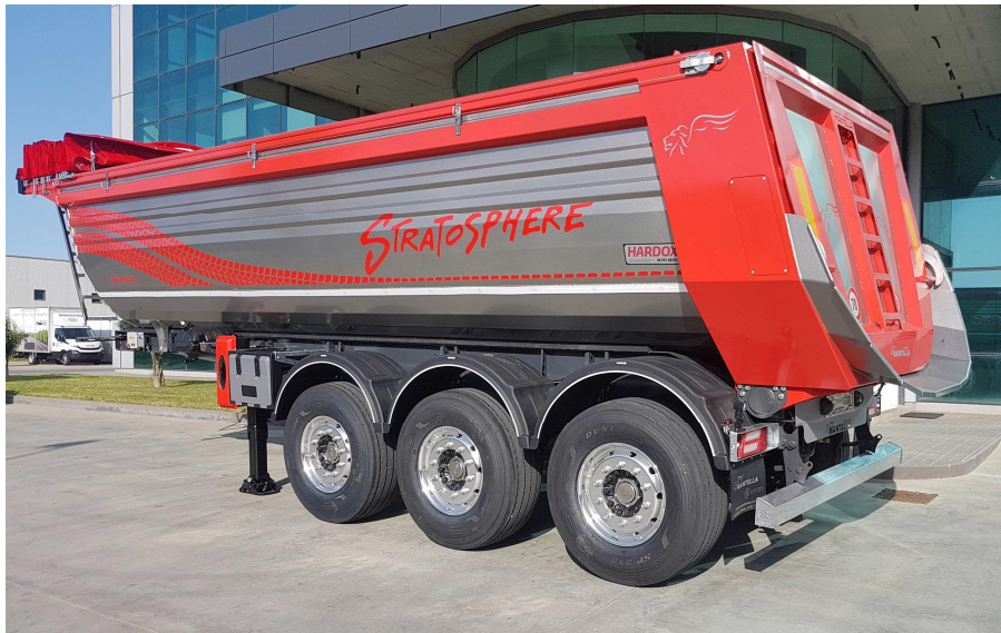
Bild 1: Der Kipperanhänger von Mantella ist um mehr als 500 kg leichter als herkömmliche Konstruktionen. Die U-förmigen Aufbauten aus Hardox® 500 Tuf wiegen 365 kg weniger und das Fahrwerk aus Strenx® 960 ist um 145 kg leichter. Die horizontalen Kerben erhöhen die Steifigkeit der Aufbauten und verhindern ein Ausbeulen beim Kippen.
