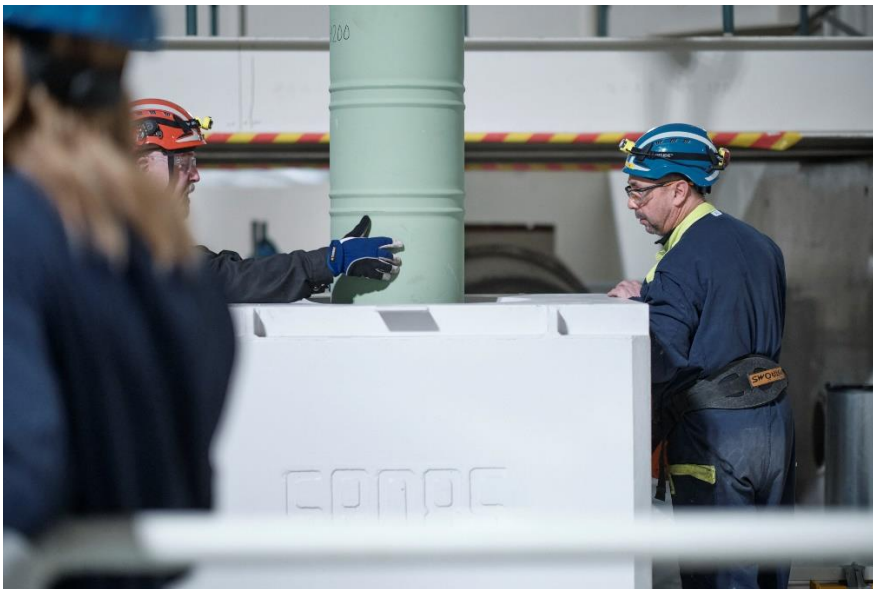
Staven klipps i kortare delar och placeras sedan i strålsäkra behållare inför transport och förvaring. Foto John Guthed
