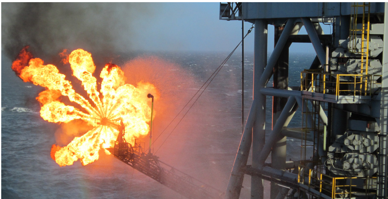
Borringen av utvärderingsbrunnen för Lille John 2 i Danmark visade ett flöde upp till cirka 1 400 fat olja per dag och visas här under ett flödestest ("drill stem test") där den producerade oljan facklas bort.
