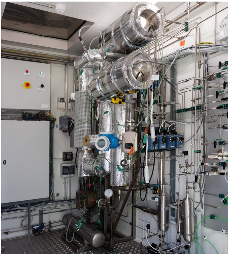
Kuva 2. VTT:n koelaitteistoa hiilidioksidin muuttamiseksi synteetikaasuksi. Synteetikaasusta tuotetaan polymeerituotannon eteeni- ja propanikaasuja.
