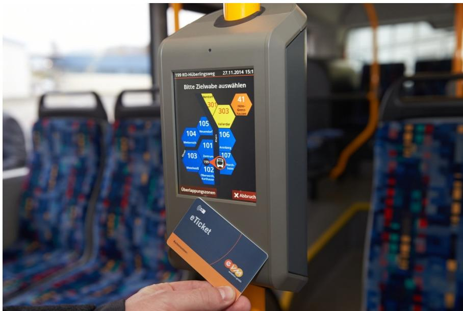
Für das neue E-Ticketing der evm Verkehrs GmbH lieferte die IVU Traffic Technologies AG die gesamte Hard- und Software und rüstete mehr als 80 Busse mit dem Kundenterminal IVU.validator aus. (Quelle: evm/Frey)
