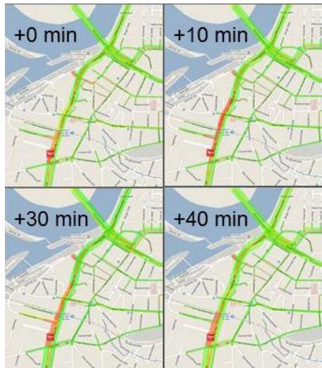
*Mit PTV Optima sieht der Verkehrsmanager bis zu 60 Minuten voraus, wie sich der Verkehr entwickeln wird. Dieses Beispiel zeigt die Stauentwicklung aufgrund eines Unfalls. Rote Balken zeigen ihm die kritischen Bereiche auf. © PTV Group*
