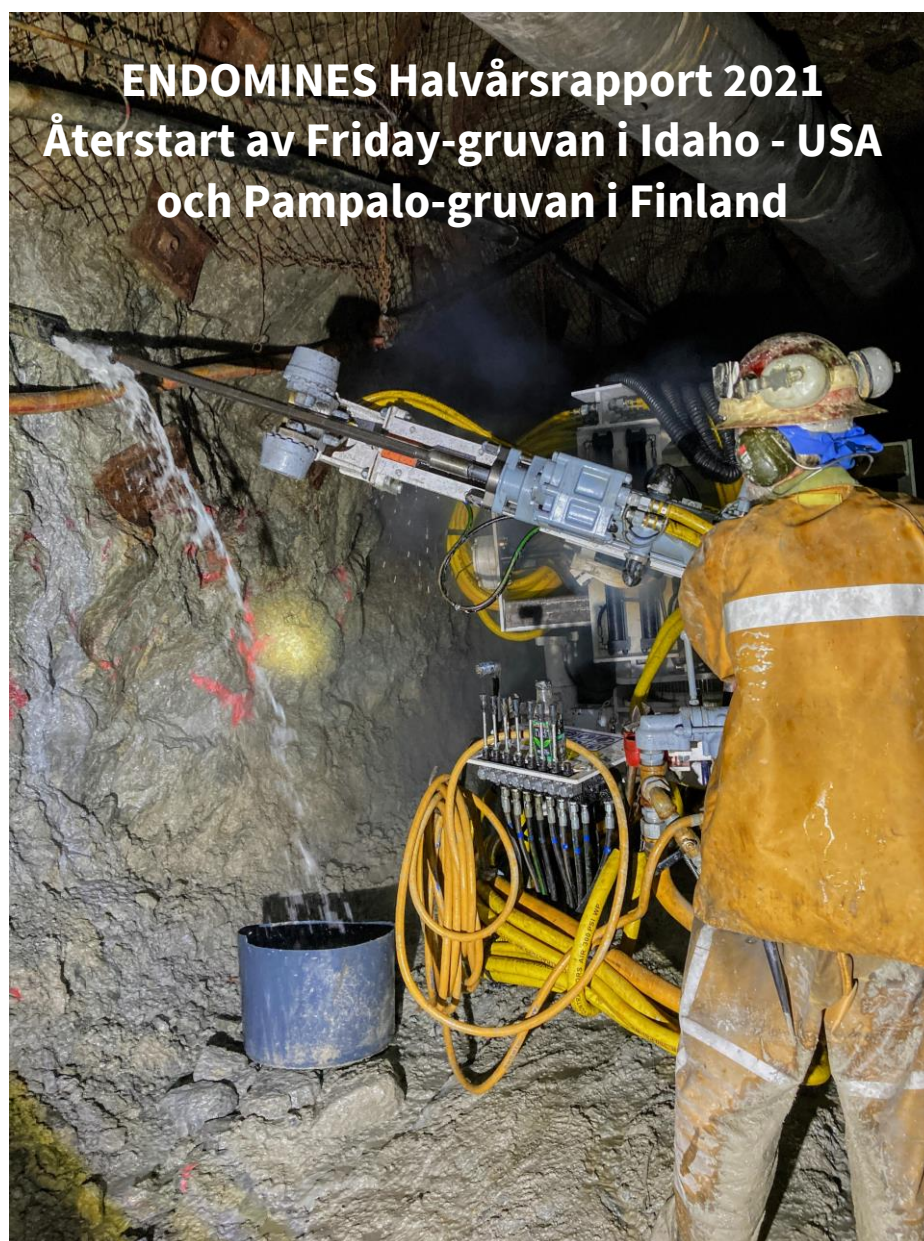
Borring av ett långhålsprov med Boart Longyear Stopemate borren vid S4550 West Haulage – Friday-gruvan
