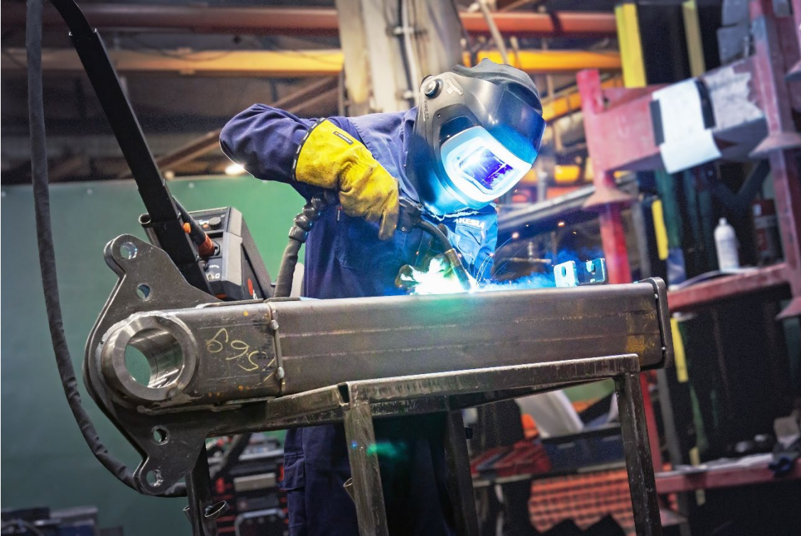
Kuva 1 Metallirakenteiden hitsausta Keslan Kesälahden tehtaalla.
