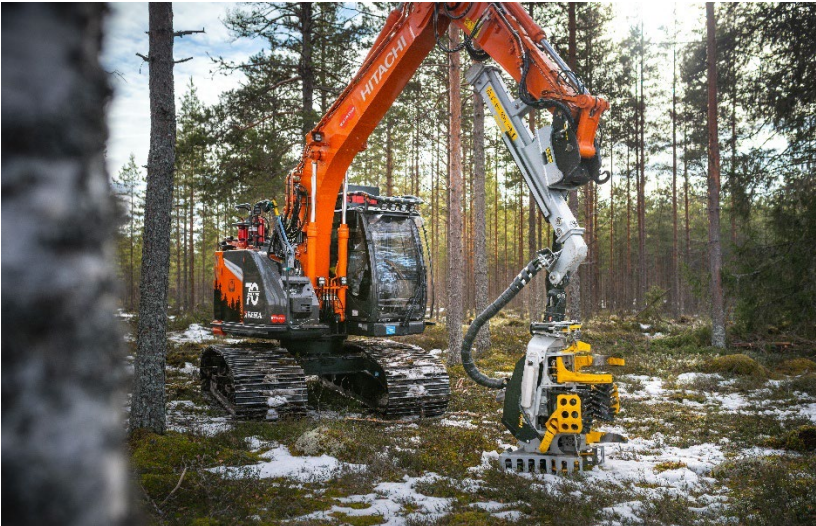
Kuva 2. Hitachi-kaivinkone & KESLA 19RH twinAX -harvesterikoura, KESLA XTender 15H, KESLA powerB -paineakkujärjestelmä
