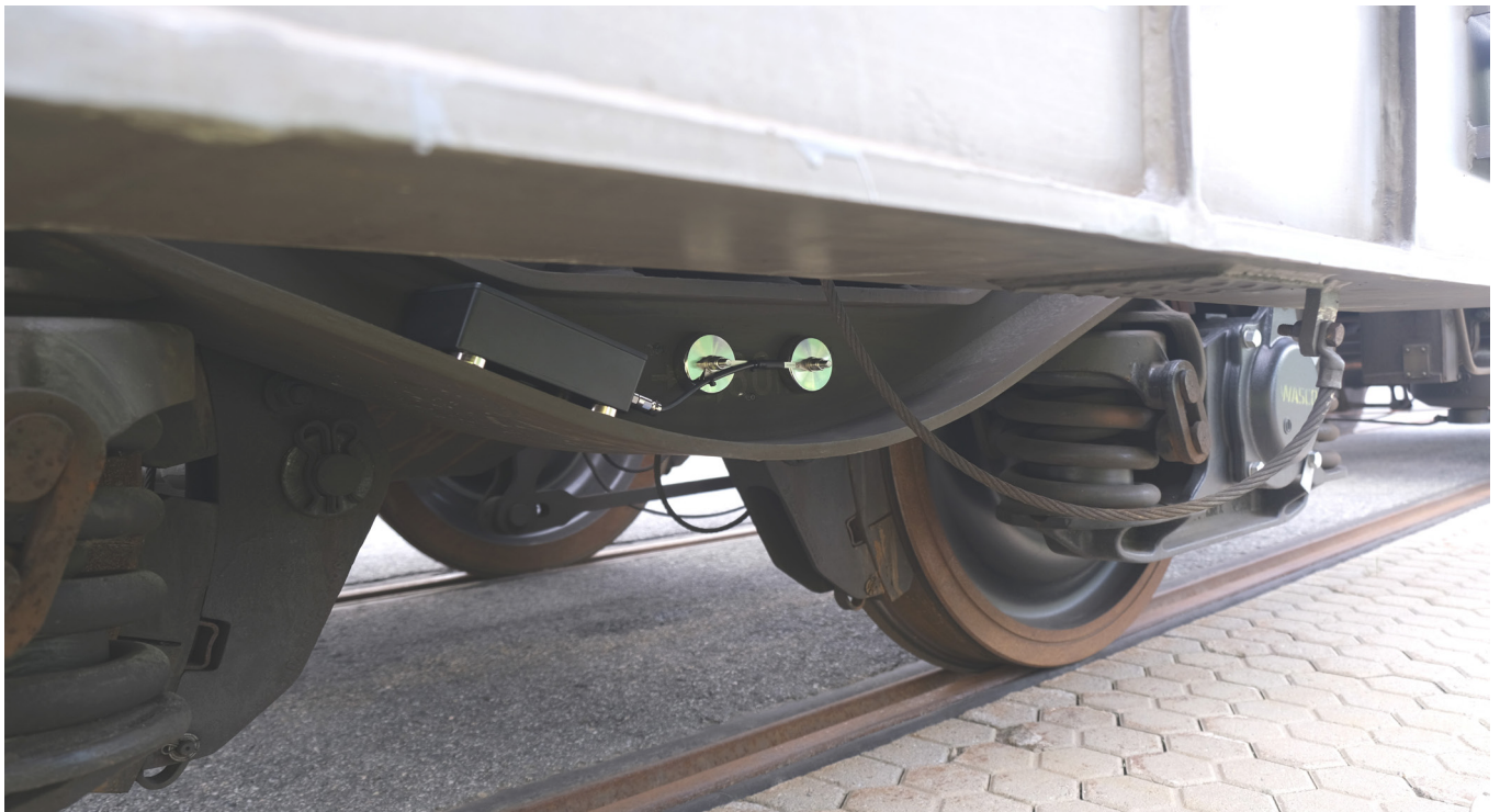
RMD:s lastviktsensor monterad på vagn. Sensorn är en del av Automatic Train Departures .
