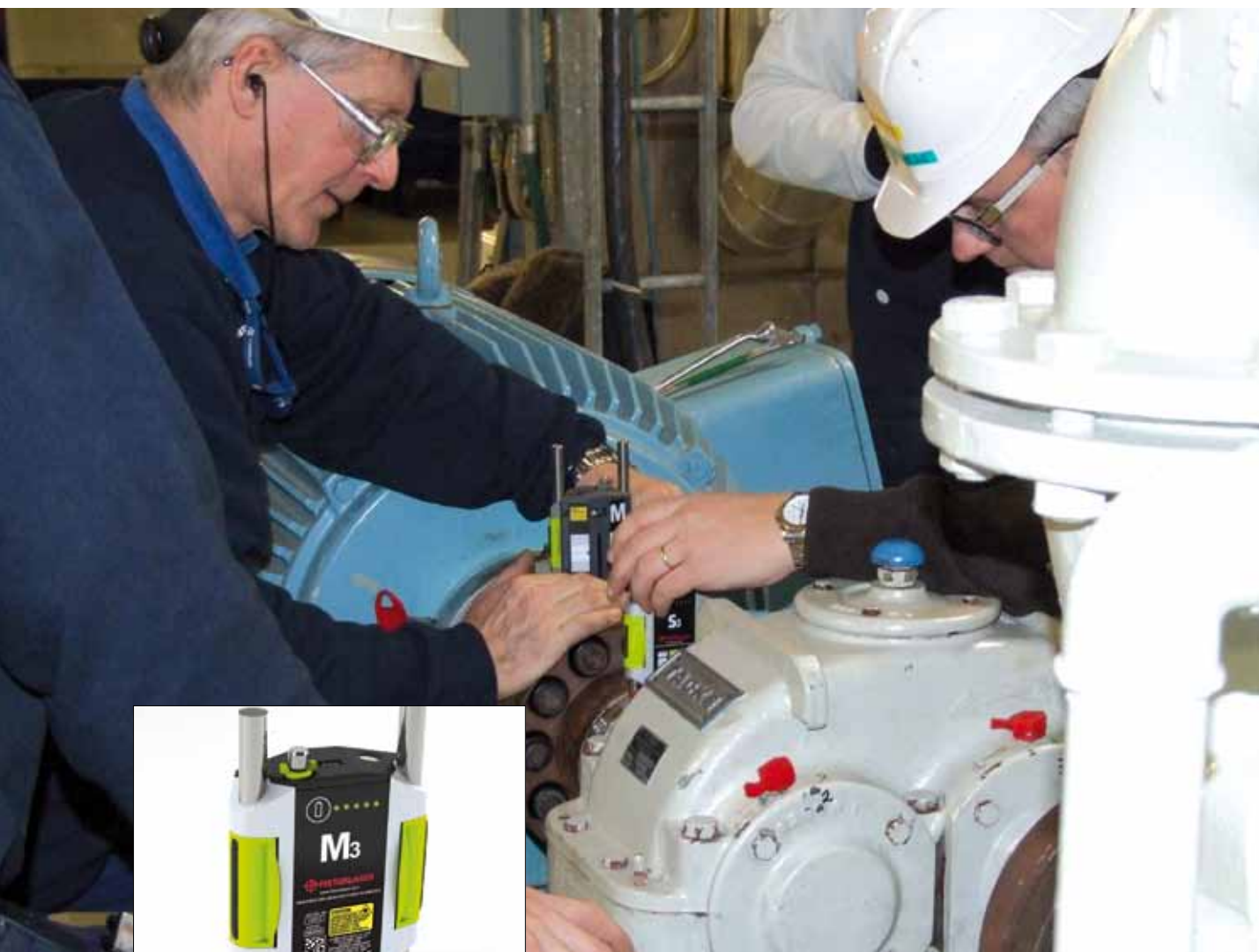
Elos Fixturlaser är marknadsledande inom området laserbaserade mätinstrument för uppriktning och positionering av roterande maskiner.
