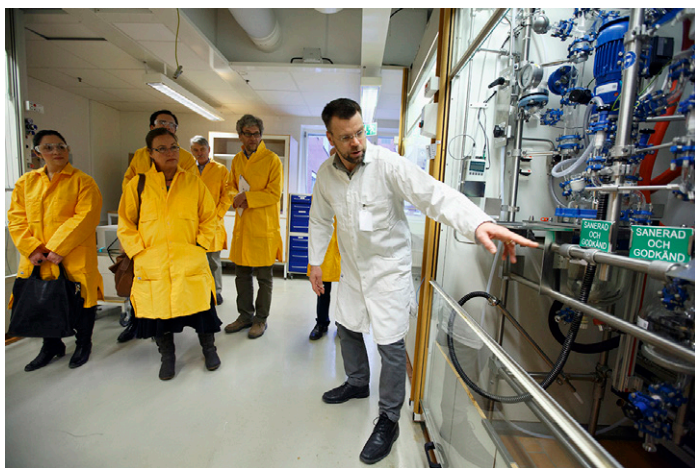
Ulf Larsson, SP Process Development, visar en uppskalningsanläggning med 5 och 10L reaktorer. Den används för att studera uppskalningseffekter för kemiska processer samt tillverkning av substans.
