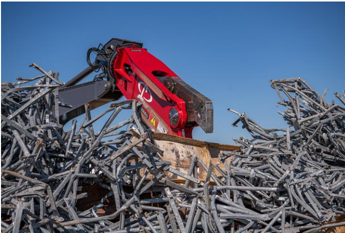
En skrotskärare från STANLEY Infrastructure för skrotåtervinning av varumärket LaBounty
