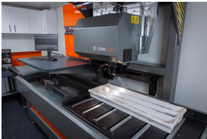
En Corescan-maskin för hyperspektral loggning av borrhäror
