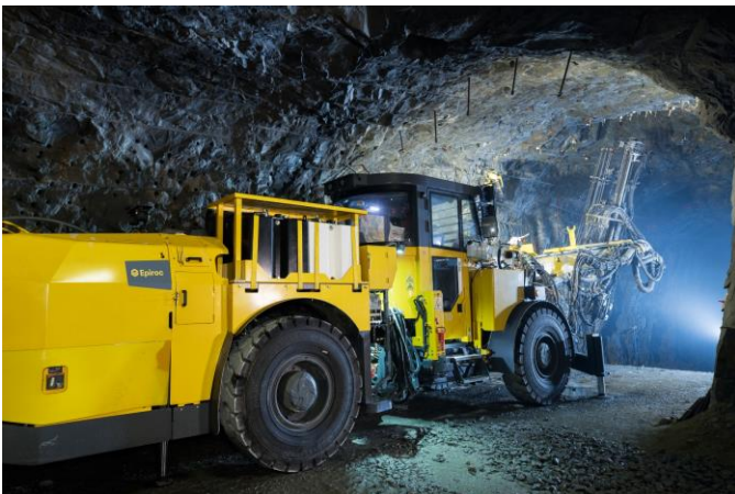
En Epiroc Boltec bergförstärkningsrigg med bulkresin-system
