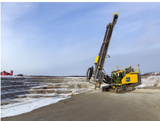
En Epiroc SmartROC D65 ovanjordsborrhjor för stenbrytning och gruvdrift, en av maskinerna som tillverkas av divisionen Surface and Exploration Drilling i Örebro.
