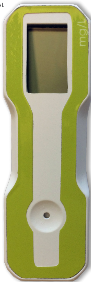
Exempel på slutlig utformning av engångstesten under utveckling. Enheten är 2 cm x 1 cm x 10 cm.
