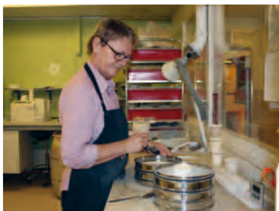
På vårt laboratorium hanteras varje dag hundratals olika prover, Eva Ahlbin är laboratorieansvarig och utför här en siktanalys.
