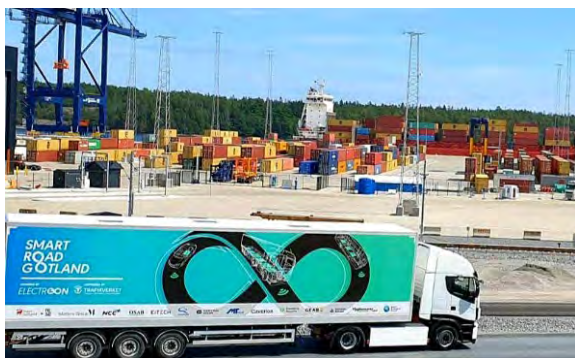
Elvägar – ett intressant alternativ för godstransporter med lastbil. Fotot t v: Den eldrivna lastbilen som deltar i Gotlandsförsöket med induktiv, trådlös teknik. Till höger: Elväg med konduktiv teknik, luftledning, Sandviken.
