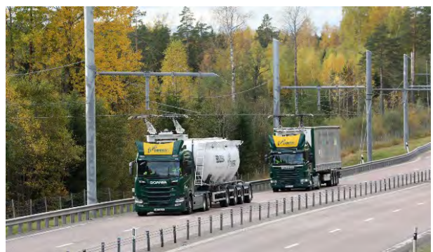
Elvägar – ett intressant alternativ för godstransporter med lastbil. Fotot t v: Den eldrivna lastbilen som deltar i Gotlandsförsöket med induktiv, trådlös teknik. Till höger: Elväg med konduktiv teknik, luftledning, Sandviken.
