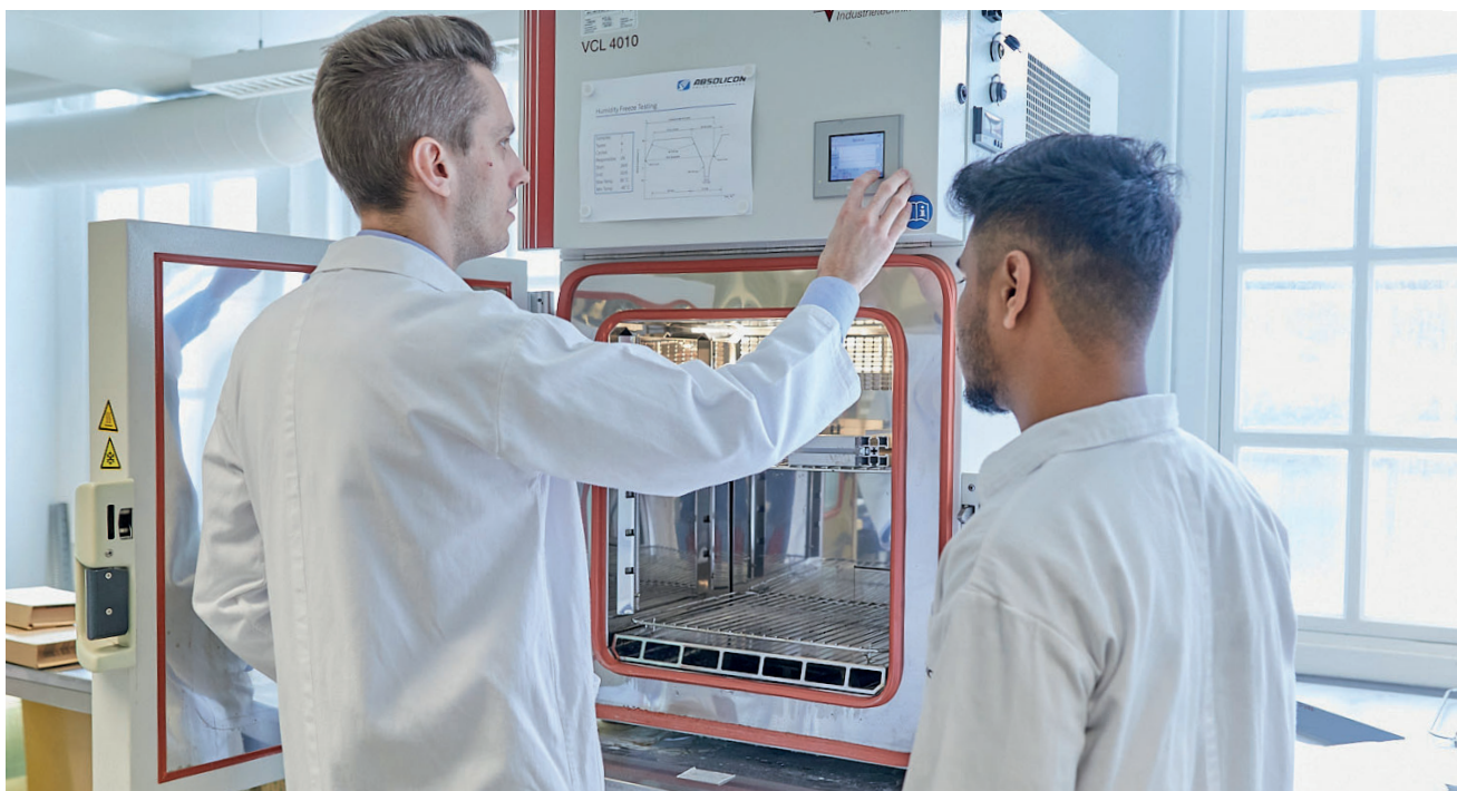
Absolicon har en klimatkammare där material testas för temperaturer och årstidsväxlingar. Foto: Tarek Sulaiman
