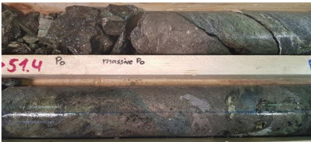
Fig.2. Borrhål HA20-018 med en massiv sulfidzon från 51.4 till 52.4m. Analysintervall 2m @ 0.45% Co, 0.63% Ni, 0.29% Cu (1.85% NiEq) från 51m, inkluderande 0.5m @ 1.59% Co, 1.4% Ni, 0.26% Cu (5.32% NiEq) från 52.2m.
