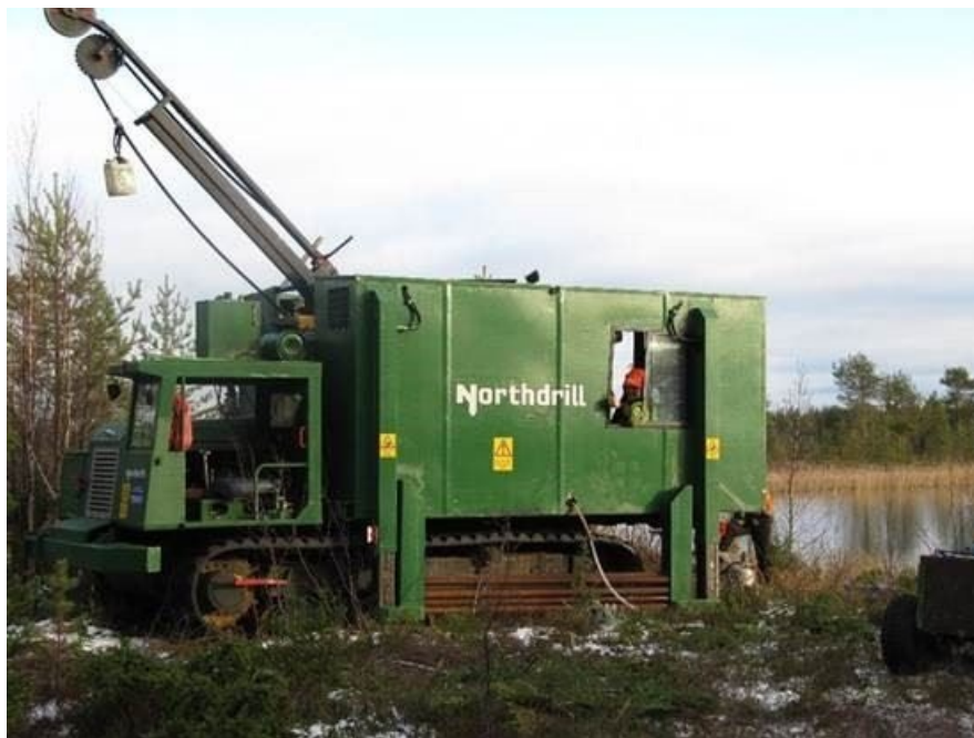
Figur 3. Northdrill Oy's borrhörningsmaskin tillverkad för åretrundsdrift i Finland.
