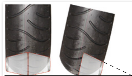
fig. 2 Hjulets omkrets är mindre vid däckets kant. Framgaffelns geometri och däckets runda profil gör att en motorcykel automatiskt svänger när den lutar.
