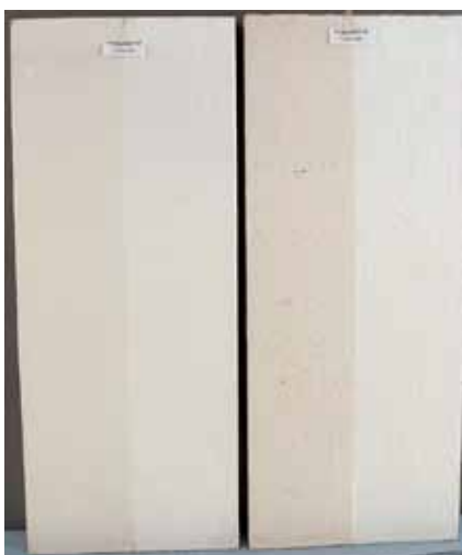
Färgsystem 40 Färgsystem 46 Caparol Schulz Alkyd Alkyd Lösningssmedel Lösningssmedel Panel 912 Panel 648 Mögel 1 Mögel 1
