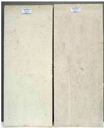
Färgsystem 40 Caparol Alkyd Lösningsmedel Panel 806 Mögel 5 Färgsystem 46 Schulz Alkyd Lösningsmedel Panel 730 Mögel 5
