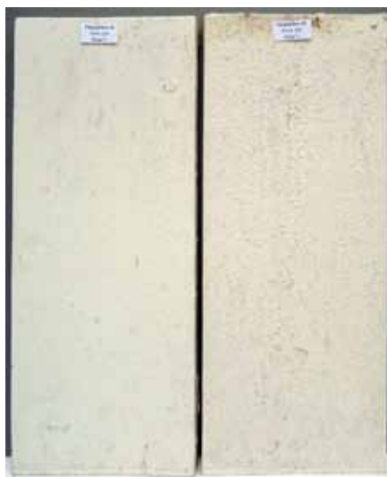
Färgsystem 40 Färgsystem 46 Caparol Schulz Alkyd Alkyd Lösningsmedel Lösningsmedel Panel 220 Panel 288 Mögel 5 Mögel 5
