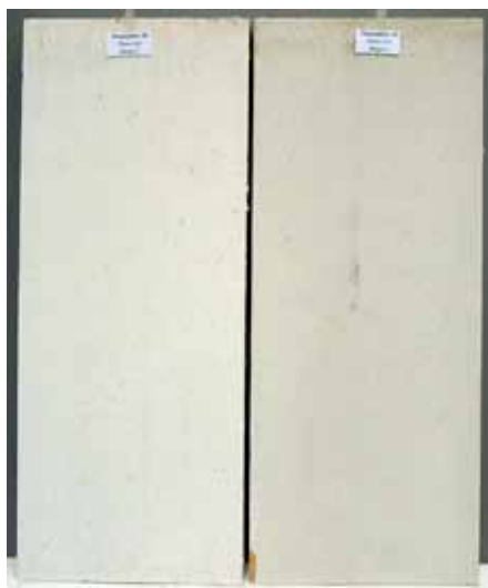
Färgsystem 29 Färgsystem 30 Norrön Nordsjö Alkyd Alkyd/linolja Lösningssmedel H 2 O Panel 520 Panel 513 Mögel 3 Mögel 3
