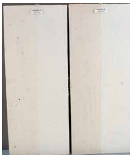
Färgsystem 40 Caparol Alkyd Lösningsmedel Panel 806 Mögel 3 Färgsystem 46 Schulz Alkyd Lösningsmedel Panel 730 Mögel 3
