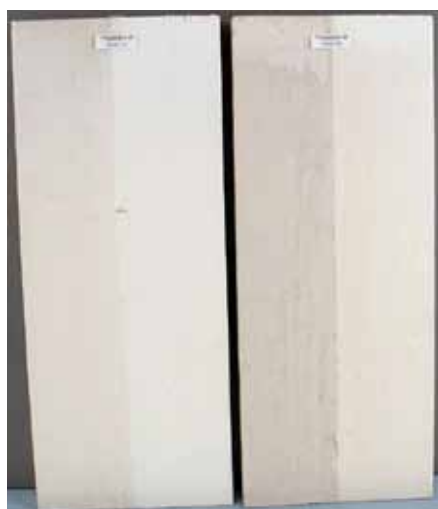
Färgsystem 29 Färgsystem 30 Norrön Nordsjö Alkyd Alkyd/linolja Lösningsmedel H 2 O Panel 112 Panel 182 Mögel 2 Mögel 3
