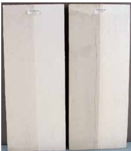
Färgsystem 29 Färgsystem 30 Norrön Nordsjö Alkyd Alkyd/linolja Lösningsmedel H 2 O Panel 78 Panel 31 Mögel 2 Mögel 2
