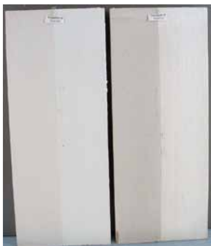
Färgsystem 29 Färgsystem 30 Norrön Nordsjö Alkyd Alkyd/linolja Lösningssmedel H 2 O Panel 520 Panel 513 Mögel 2 Mögel 2
