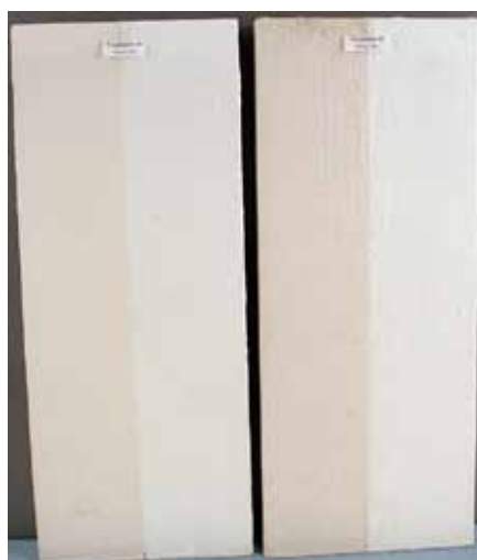
Färgsystem 40 Färgsystem 46 Caparol Schulz Alkyd Alkyd Lösningsmedel Lösningsmedel Panel 220 Panel 288 Mögel 1 Mögel 2
