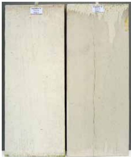
Färgsystem 29 Färgsystem 30 Norrön Nordsjö Alkyd Alkyd/linolja Lösningsmedel H 2 O Panel 78 Panel 31 Mögel 3 Mögel 3
