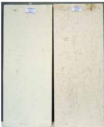
Färgsystem 40 Färgsystem 46 Caparol Schulz Alkyd Alkyd Lösningssmedel Lösningssmedel Panel 912 Panel 648 Mögel 3 Mögel 5
