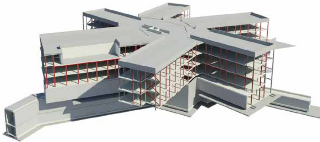
Byggnad 22:s pelar-balkstomme.
